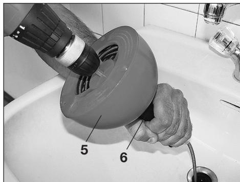
**Achten Sie darauf, dass bei der Rückführung der Reinigungsspirale in das Gehäuse die Bohrmaschine vom Sechskantadapter getrennt ist.**
