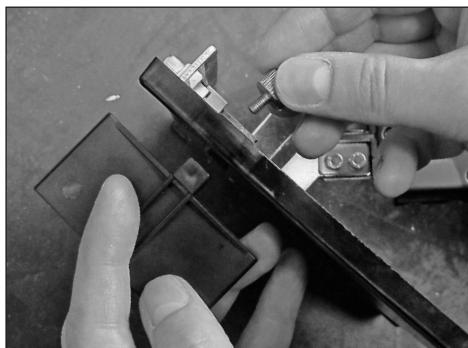
Namestitev izbrane plošče za rezanje
